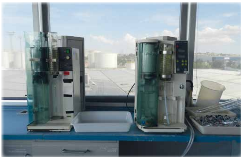
Imatge 16. Destil·ladors automàtics per realitzar l'anàlisi del nitrogen pel mètode Kjeldahl.
