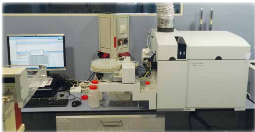
Imatge 27. Espectròmetre de masses amb plasma acoblat. Permet mesurar la majoria d'elements de la taula periòdica en un rang dinàmic lineal amb precisió de nanograms per litre.
