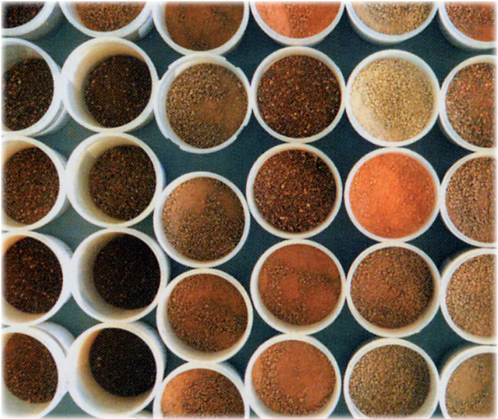
Fotografia 2.1a. Mostres de terra preparades per ser analitzades. L'estandardització dels procediments de preparació de la mostra i anàlisi permet la comparativa dels resultats en base a les taules i treballs de referència.
