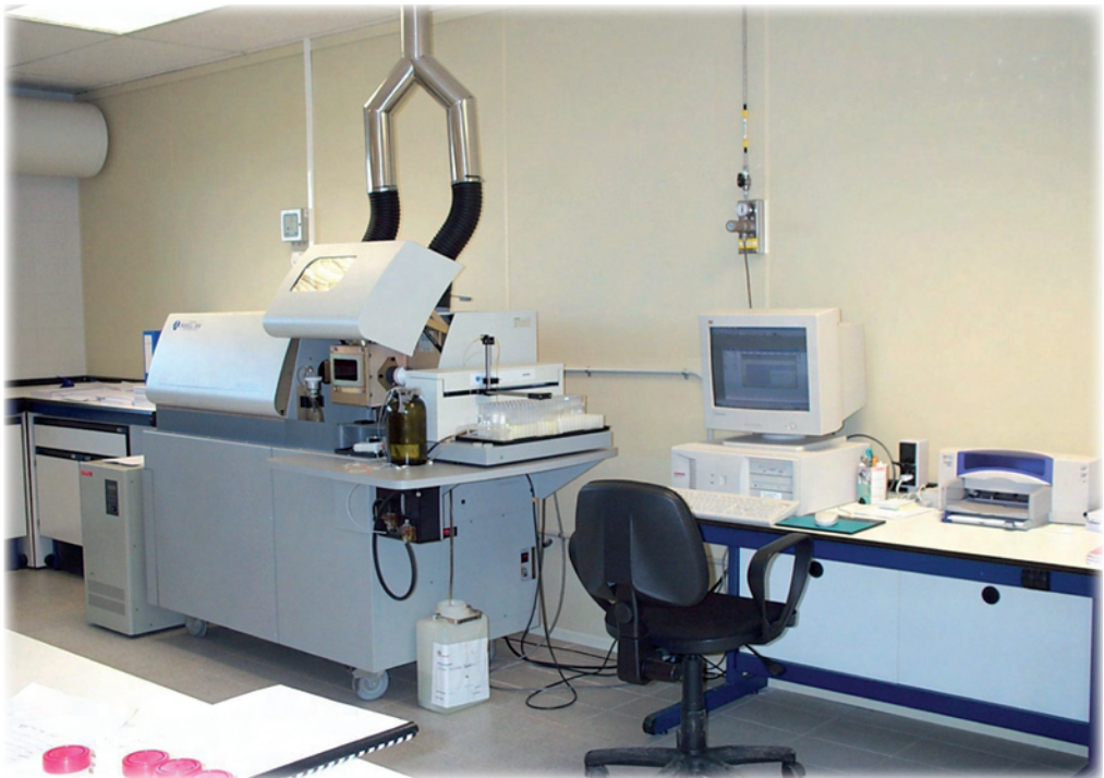
Fotografia 1b. Detall d'un equip ICP. L'espectrofotometria d'emissió per plasma (ICP) ha permès augmentar de forma considerable la capacitat de treball dels laboratoris a efectes d'elements analitzats i rang de treball (foto cedida per LAF).
