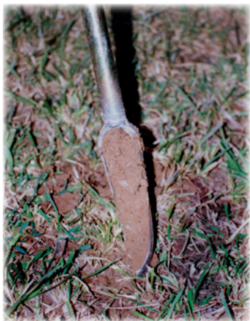
Fotografia 2.3.2a. Detall de la barrina en el moment de l'obtenció de la mostra. Les barrines tipus Edelmann presenten una excel·lent ergonomia per a l'obtenció de la mostra.
